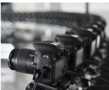
Aufwändiges Equipment liefert den Effekt eines bewegten Standbilds, ganz im Stil der »Matrix«-Filme: 32 Kameras werden im Halbkreis auf einer Schiene montiert und nacheinander alle zwei Millisekunden ausgelöst.
